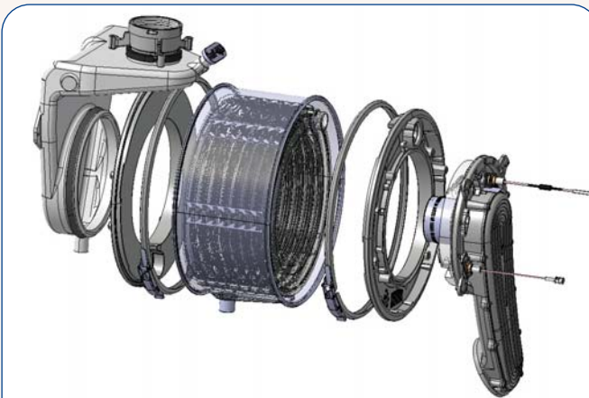
Sercem kotła jest wymiennik o wyjątkowej konstrukcji, wykorzystujący zjawisko kondensacji
