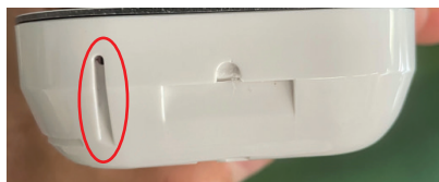
Na programatorze T200 wcisnąć jednorazowo przycisk w obudowie – cienkim narzędziem (brak w zestawie).
