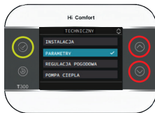
Wybrać opcję INSTALACJA, zatwierdzić przyciskiem MENU ✓
