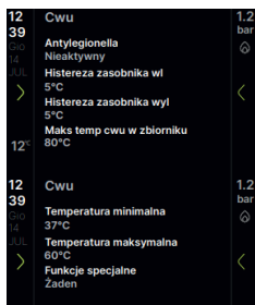
W funkcjach Temperatura minimalna, maksymalna ustawiamy temp. wody w zasobniku c.w.u.
