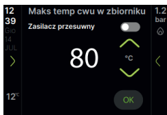
W funkcjach Temperatura minimalna, maksymalna ustawiamy temp. wody w zasobniku c.w.u.
