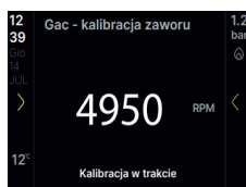
W trakcie procedury kalibracji na wyświetlaczu będzie wskazywana aktualna liczba obrotów wentylatora
