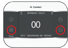
Jednocześnie nacisnąć dwa dolne przyciski (około 2 sekund) by wprowadzić hasło do strefy technicznej.
